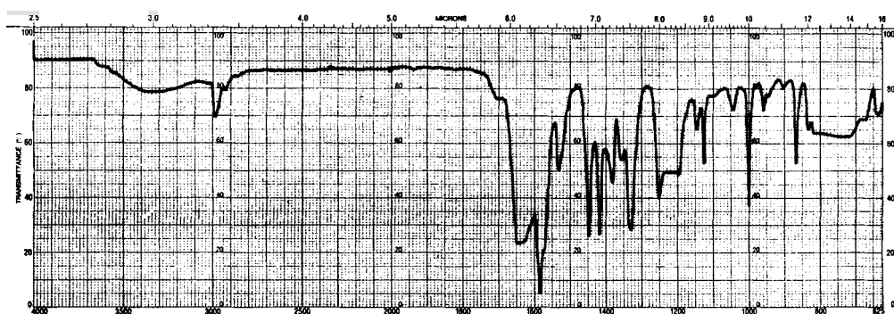
b) IR.-Spektrum von Ferrithiocin in \text{CHCl}_3
